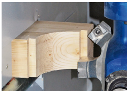
Mecanizado de la cabeza del cabrio
