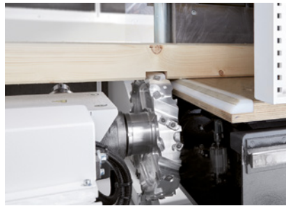
Entalladuras con fresa de disco
