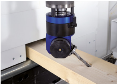
Mecanizado de fresado de 5 ejes
