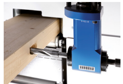
Producción de mortajas y escotaduras
