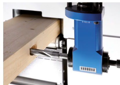
Fabrication de mortaises et de poches
