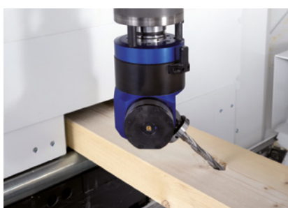
Fraisage à 5 axes
