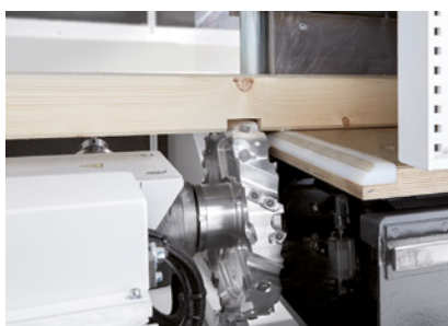
Moisage avec fraise disque
