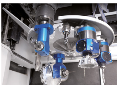
Changeur d'outils à 12 positions
