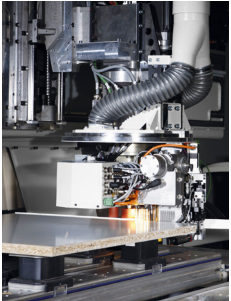
Creación de cantos con LaserTec en piezas moldeadas con junta invisible
