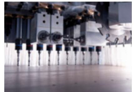
Técnica de taladrado de alta velocidad con sierra de ranurar
