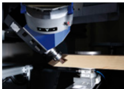
Fresado de una unión de rebaba para construcciones de postes y travesaños
