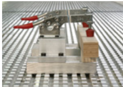
Fijación de medios de sujeción especiales: la mesa reticular de aluminio con guías de cola de milano garantiza la fijación precisa y por arrastre de forma de los elementos de sujeción.
