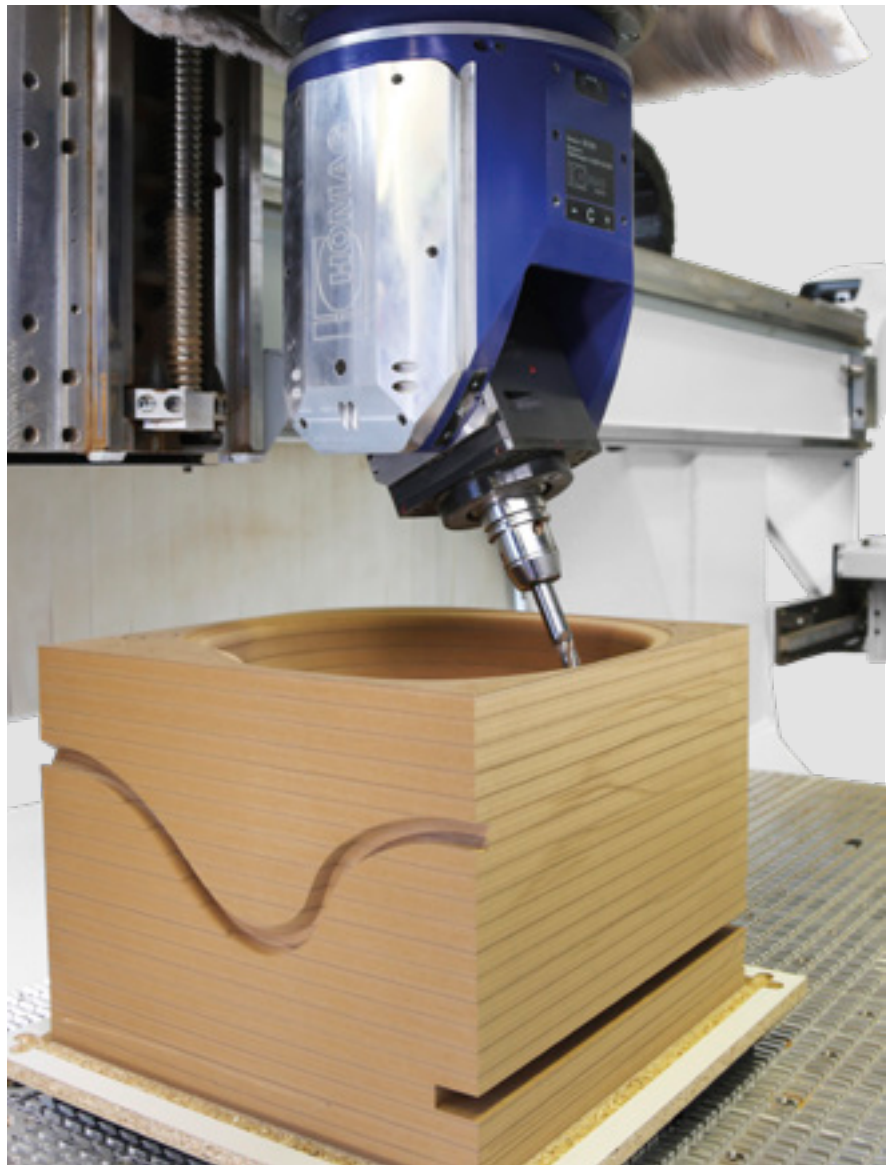
Fresado de componentes con gran altura Z
