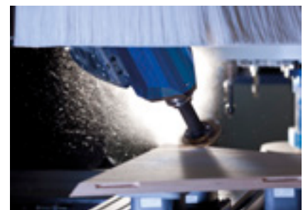
Fresado de ranuras inclinadas para una unión de placas
