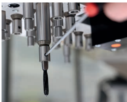
Weldon Wechselsystem für einen Bohrerwechsel mit Werkzeugen
