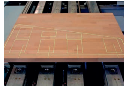
Laserprojektion der Spannmittel und der Werkstückkontur für optimale Ausnutzung und einfaches Auflegen von Rohteilen, die nicht an den Anschlängen ausgerichtet werden können.
