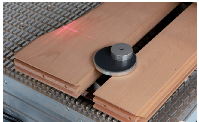
Laserpositionierung Die Fräskontur kann durch den Fadenkreuzlaser abgefahren werden
