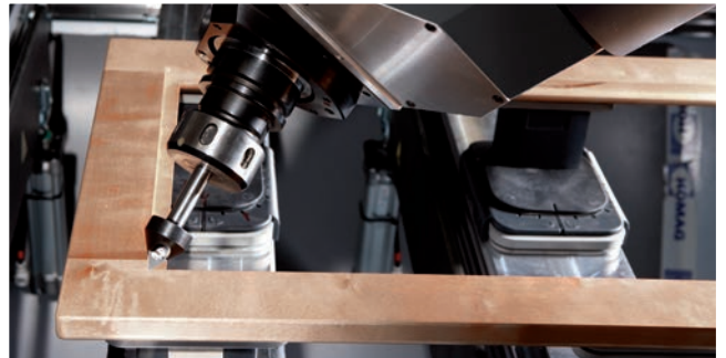
Eckiges Ausspitzen einer Glasfalz-Ecke
