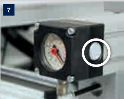
**Bouton-poussoir pour le démarrage du programme** – un bouton-poussoir sur le profil de butée gauche et droit permettent le démarrage du programme d'usinage.
