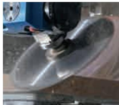
**Sciage, fraisage, perçage quelque soit l'angle – agrégat FLEX5+** avec réglage d'angle automatique. Un agrégat unique pour broches 4 axes qui couvre 90% des applications 5 axes.
