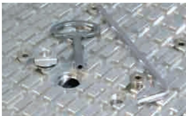
**Raccords de vide 1" à ouverture rapide** à l'aide de la clé de l'armoire de commande, ouvertures de vide avec filetage fin pour la fixation des éléments de serrage
