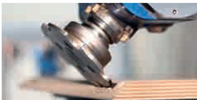
Fraisages pour ferrures d'assemblage
