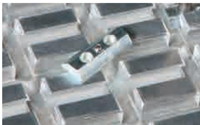
**Coulisseaux** avec filet pour la fixation adaptée aux formes des éléments de serrage dans le guidage à queue d'aronde
