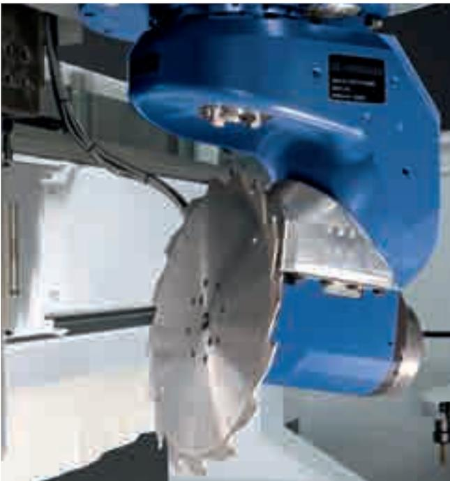
**Tête intelligente à 5 axes DRIVE5CS**, conception compacte et courses réduites. Une dose maximale de technologies dans un espace réduit, mais sans limitation des possibilités d'usinage. Broches refroidies par liquide dotées d'une puissance de fraisage de 10 kW (12 kW en option) pour un travail puissant. La conception compacte optimise l'espace de travail (si vous utilisez par exemple une lame de scie de 350 mm, sous le capot).
