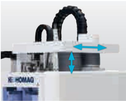
**Aspiration efficace** malgré une puissance de raccordement réduite grâce à la détection et l'évacuation optimisées des copeaux. Le capot est réglable en continu par moteur.
