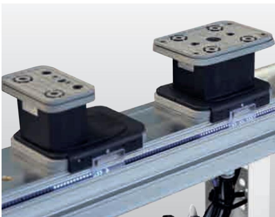
**Système à LED** – un équipement rapide et fiable. Les bandes lumineuses à LED indiquent aussi bien le type de ventouse et son orientation que la position des ventouses et des consoles.
