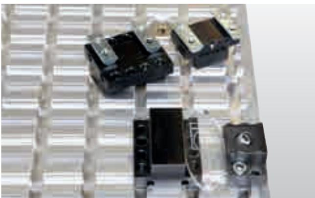
**Table rainurée en aluminium** avec rainures trapézoïdales pour une fixation adaptée à la forme et flexible des éléments de serrage de tous types.
