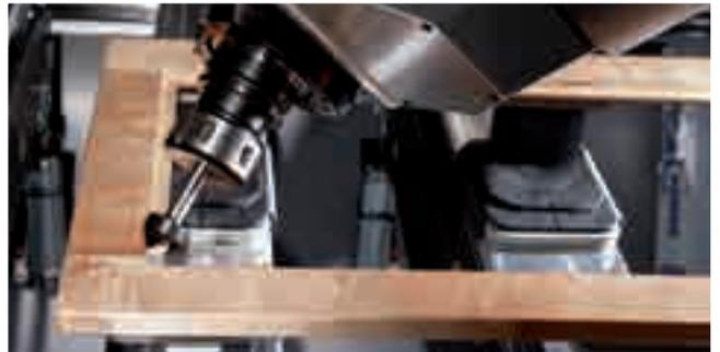
Usinage précis d'une feuillure pour l'insertion d'une vitre
