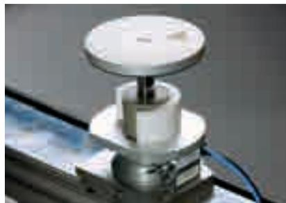
**PowerClamp** : pour l'usinage sur les 6 côtés de composants en bois massif (panneau de base rabattable), par ex.
