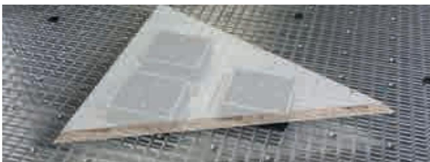
**Serrage par le vide** : éléments de serrage par le vide pour une utilisation dans les rainures de la table rainurée.
