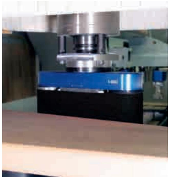
**Interface pneumatique** – Une interface brevetée avec un support 3 points sur tous les axes C et en option à la DRIVE5CS permet l'utilisation d'agrégats palpés pour un arrondissement supérieur et inférieur précis, indépendamment des tolérances en épaisseur.
