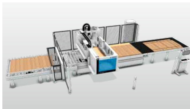
Soluzione 2R+ Rulliera in entrata come interfaccia per automatizzazioni a monte
