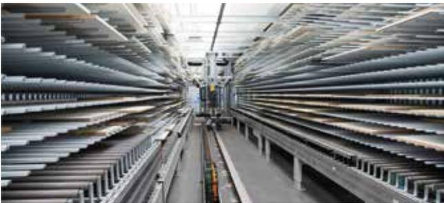
**Compilación entre el mecanizado de formato y canteado y taladrado:** Almacenamiento y compilación, p. ej. para el orden de montaje y recorrido, o por el color, forma, medida etc.
