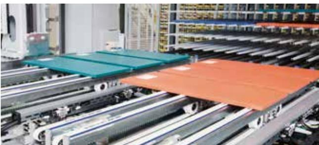
**Alta capacidad de almacenamiento gracias al posicionamiento ideal del material ya en el área de recogida:** Se posicionan el material exactamente ya con la toma de las piezas de la cinta transportadora para llenar los compartimiento del estante de manera ideal.
