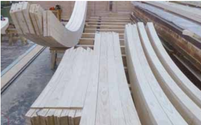
Gebogene Brettschichtholzelemente werden bspw. in Brücken oder Kirchen eingesetzt. Bent glulam elements can be used for bridges or in churches.
