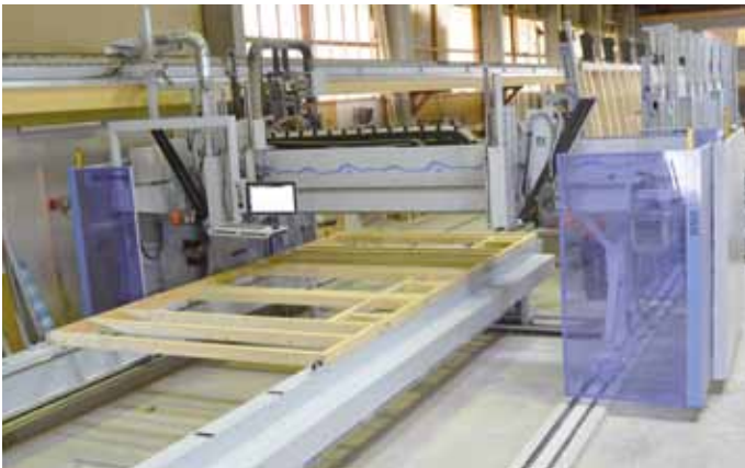
Fertig erstelltes Riegelwerk. | Finished frame work.
