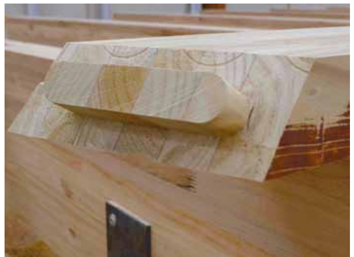
Mit dem Massivholzportal hergestellter schräger Zapfen. Inclined tenon, produced with the solid wood portal.
