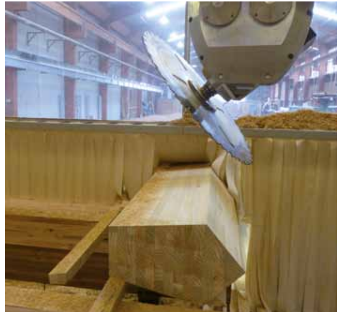
Mit Hilfe der 5-Achs-Technologie werden unter anderem Firstträger hergestellt. / 5 axis technology enables fast and accurate manufacture of ridge beams, amongst other things.
