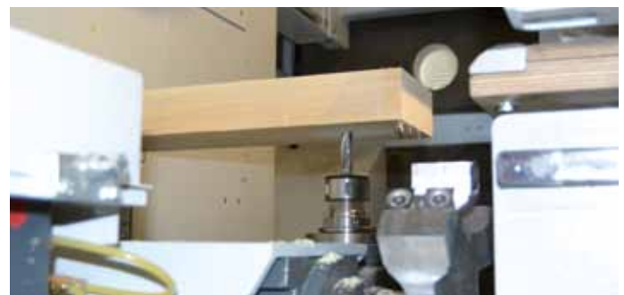
Herstellung eines Zapfenlochs. | Producing a mortise.
