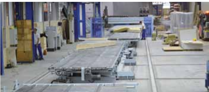
Die neue Produktionslinie für Sonderbauteile mit 6 Arbeitstischen und einer Multifunktionsbrücke. Die Anlage kann gleichermaßen Kniestöcke ab 40 cm Höhe und Wandelemente bis 14,50 m Länge produzieren. The new production line for the manufacture of special elements consisting of 6 assembly tables and a multifunction bridge. The line is capable of producing both jambs of 40 cm (and higher) and wall elements of up to 14.50 m long.
