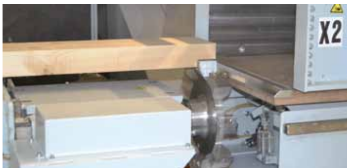
Ausblattung mit dem Unterfluraggregat. Performing notches by means of the underfloor unit.
