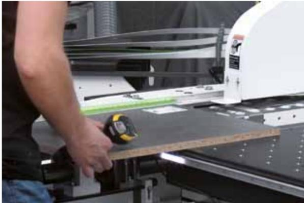
Was mit dem Bediener-Assistenz-System intelliGuide für die Plattenaufteiltechnik begann, adaptiert HOMAG jetzt auf Kantenleimmaschinen. Bei Plattenaufteilsägen reagiert das Bediener-Assistenz-System (in der Ausbaustufe „professional“) auf Handlungen des Sägenbedieners. So ändert intelliGuide hier zum Beispiel flexibel die Schnittreihenfolge, wenn der Anwender die Säge mit einem anderen als dem vorgesehenen Teil beschickt.
