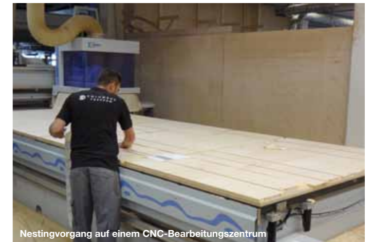
Nestingvorgang auf einem CNC-Bearbeitungszentrum
