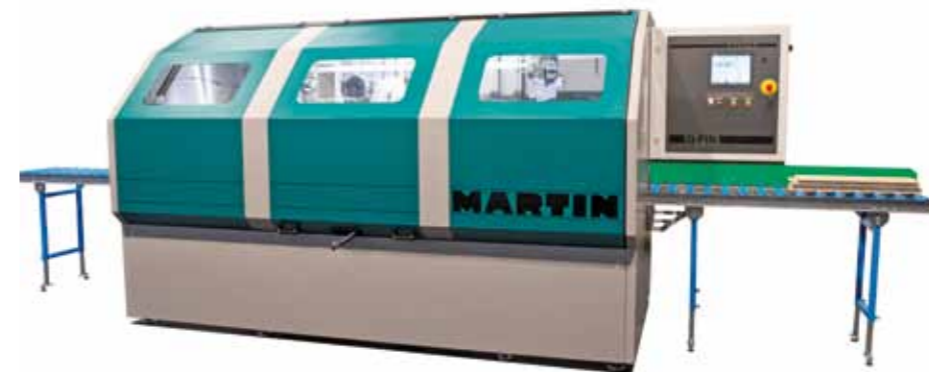
Neuheit: Die neue Martin Q-FIN zum geometrisch definierten Querkappen von Holzfasern
